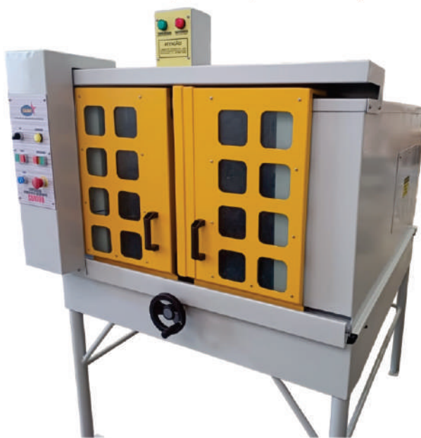
Sistema de regulagem manual do disco. Para uso de disco de 350 à 500mm.
