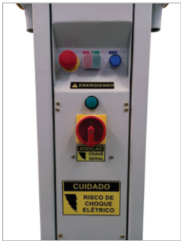
Painel embutido que evita acúmulo de resíduos. Chave geral e sinaleiro de equipamento energizado.
