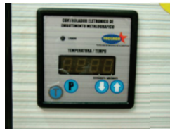
Controlador eletrônico protegido contra sobrecargas elétricas que controla: resistência elétrica de aquecimento (pirômetro), tempo de cozimento (cura) do baquelite e temperatura final do ciclo que determina o desligamento automático de todo o equipamento
