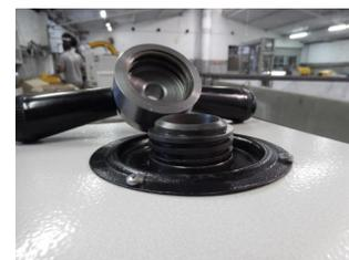
Tampa de fechamento via rosca quadrada que proporciona alta vedação. Câmara e êmbolos fabricados em aço com liga de alta dureza com superfícies polidas.
