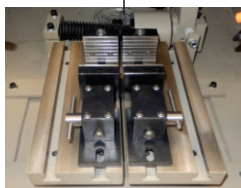
Mesa móvel com dois fusos e movimento transversal de 50mm (opcional).
